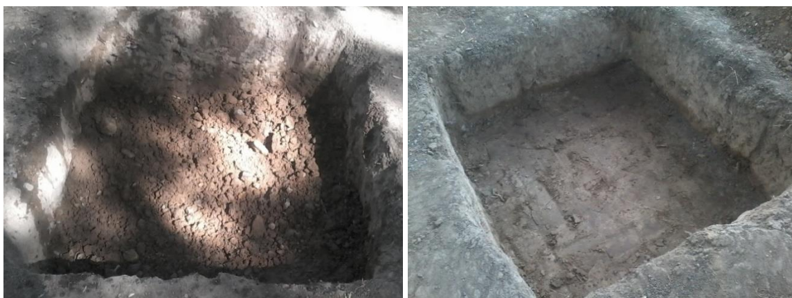
3.18-rasm. Gruntning kichik tadqiqot uchastkasida zichlanmasdan oldin va zichlangandan keyigi holati.
