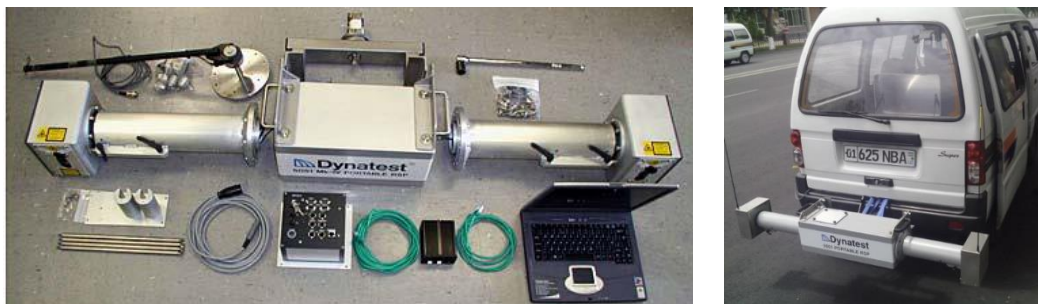
1.52-rasm. Yo'l qoplamasi yuzasining bo'ylama profilini o'lashda foydalaniladigan lazer profilometri (Dynatest 5051 IV) ning komponentlari
