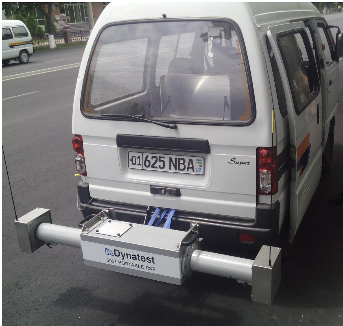
Dynatest 5051 lazer profilometri yordamida qoplama ravonligini o'lchash jarayoni
