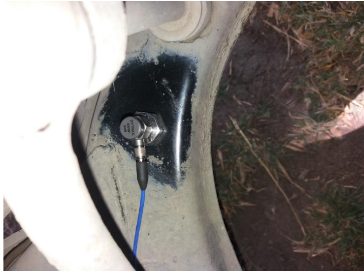
Dytran akselerometerlar yordamida ravonlikni o'lchash jarayoni
