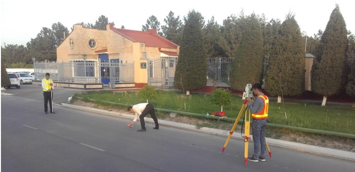
TS 06 Elektorn taxeometri yordamida ravonlikni o'lchash jarayoni
