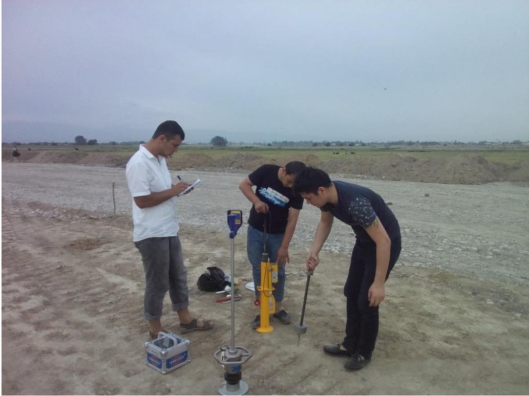
Turli xil qurilmalar o'rtasidagi bog'liqlikni aniqlash maqsida zichlangan yo'l poyida sinov o'tkazish jarayoni
