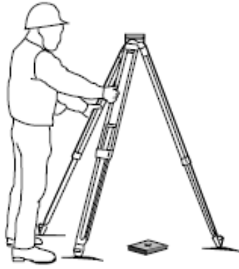
1.11-rasm. Shtativni erga maxkamlangan nuqta ustida gorizontol xolatda o‘rnatish
