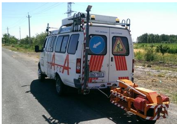
1.51-rasm. «Trassa» kompleks yo‘l laboratoriyasi
