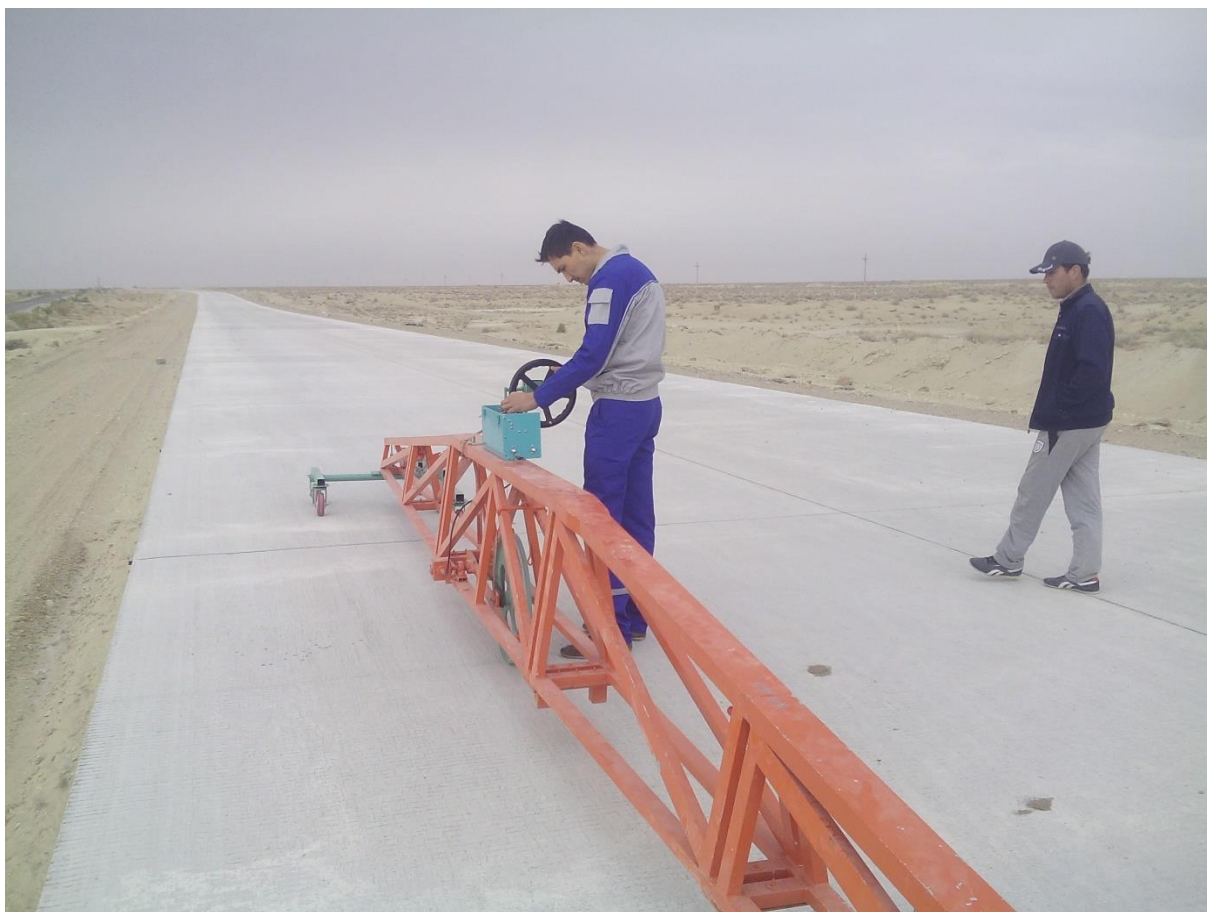
Rainhard profilometri yordamida ravonlikni o'lchash jarayoni
