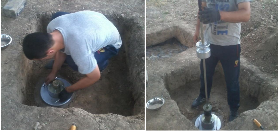
3.21-rasm. Qatlam modelining elastiklik modulini aniqlash jarayoni.
