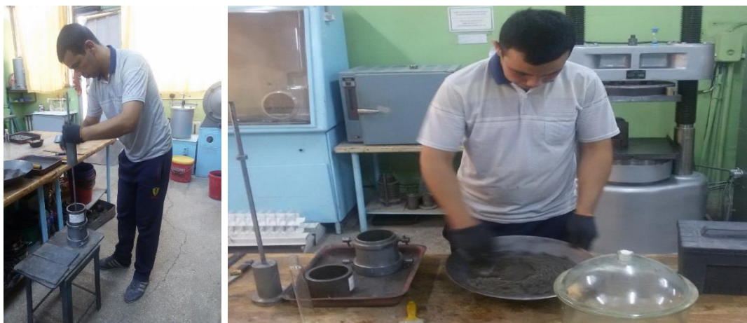
3.19-rasm. Standart zichlashtirish uslubida gruntning optimal namligi va maksimal zichligini aniqlash jarayoni.
