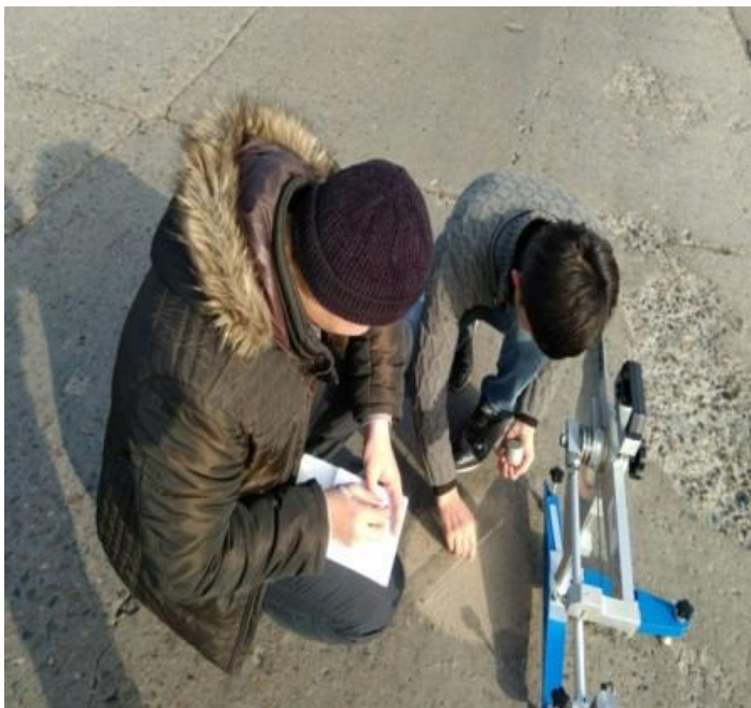
Cooper Pendulum Skid Tester qurilmasi va qumli dog' usuli natijalarini o'zaro solishtirish uchun qoplamaning bilan tishlashish sifatini aniqlash jarayoni
