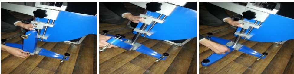
2.18-rasm. Orqa tayanchni ushlab turuvchi gayka va shayba echiladi. Bu xolatda orqa tayanch qo‘shimcha yordamchi sifatida ishlatiladi. Orqa tayanch pastga tushuriladi. Orqa tayanch ramaga mahkamlanadi. Orqa tayanchni asosiy ramaga mahkam biriktiriladi
