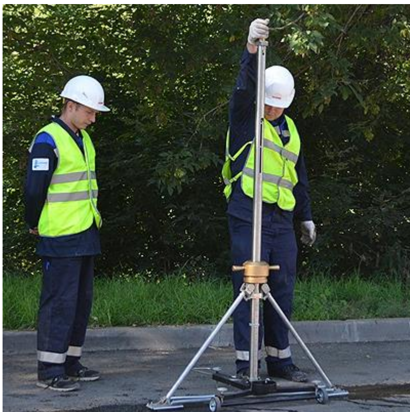
2.5. Tishlashish koeffitsientini MAYI portativ asbobi yordamida aniqlash jarayoni.
