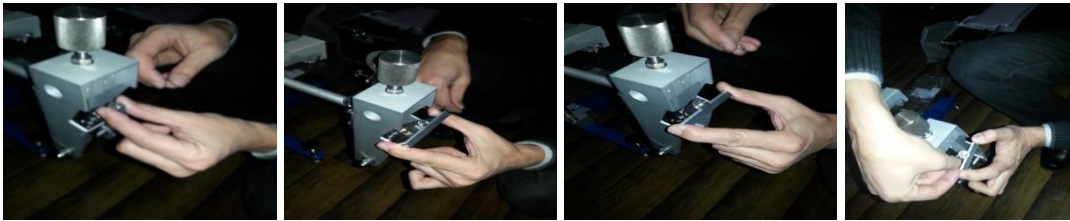
2.20-rasm. Ishqalanish va emirilishga sinaladigan namunani o‘q bo‘lib xizmat qiladigan mexanizmga mos holda tayyorlanadi. Ushlab turuvchi shpilka va dastlabki shayba olinadi. Ishqalanish va emirilishga sinaladigan namunani o‘q bo‘lib xizmat qiladigan mexanizmga o‘rnatiladi. Ishqalanish va emirilishga sinaladigan namuna ustidan bosilib gayka va shayba joyiga qotiriladi.
