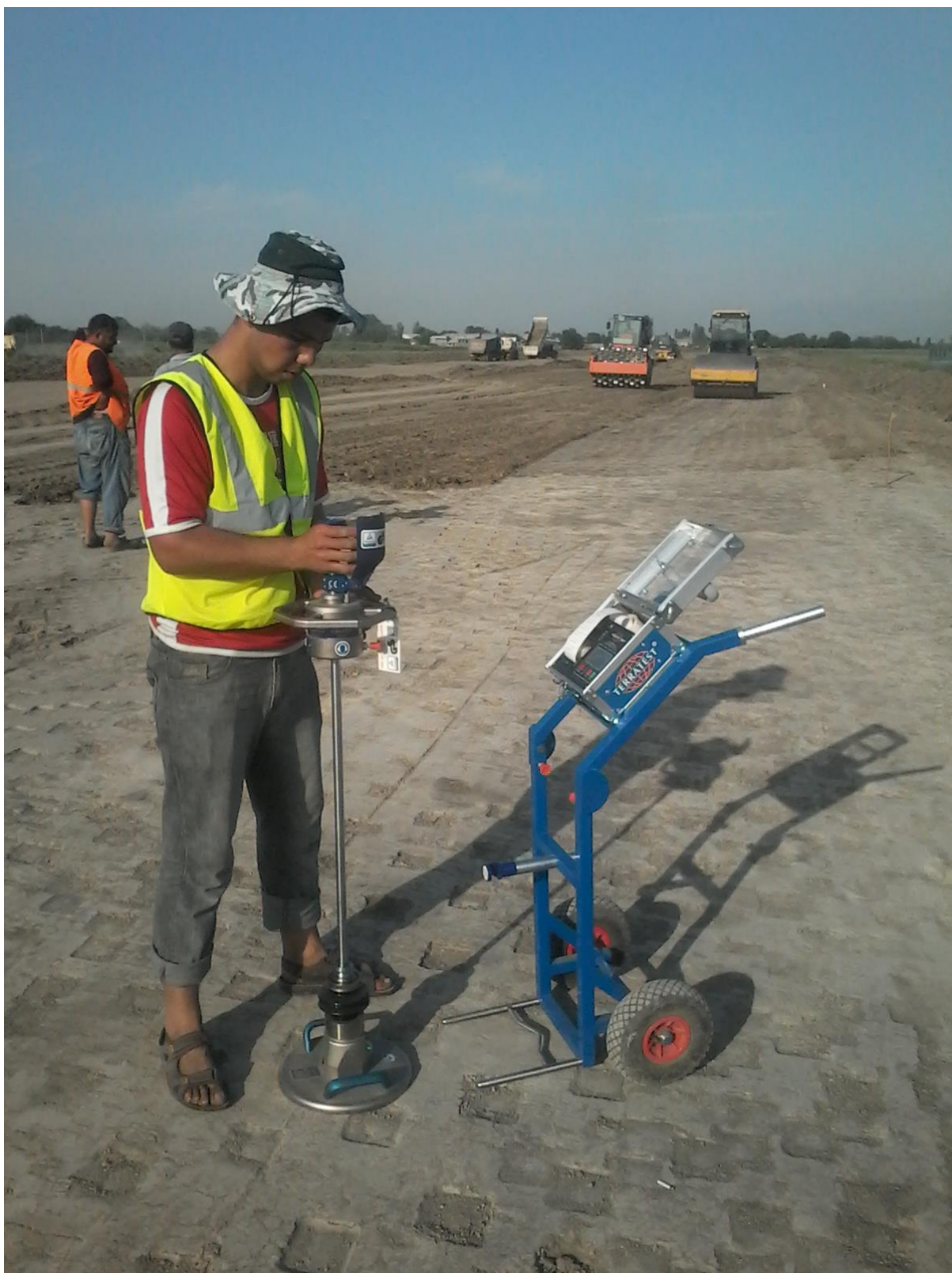
“Terratest 5000 BLU” qurilmasi yordamida zichlangan yo‘l poyining mustahkamligini o‘lchash jarayoni
