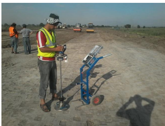
3.25-rasm. Qurilish obyektida gruntning elastiklik moduli va zichligini aniqlash jarayoni.
