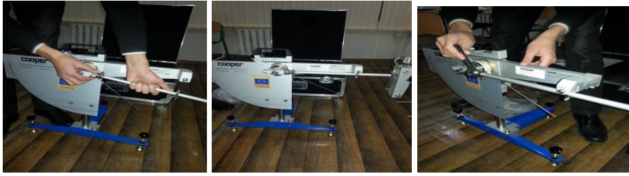
2.19-rasm. Aylanuvchi golovkaga o‘q bo‘lib xizmat qiluvchi richag o‘rnatiladi va richag gaykasi qo‘l yordamida qotiriladi. Richag ushlab turuvchi blokka joylashtiriladi. Richag gaykasi “C” shaklidagi (gaishniy klyuch) yordamida qattiq tortiladi. Kronshteynni aylanuvchi asosga maxkamlanadi, adapter gaykasini kerakli klyuch (gaishniy) yordamida qotiriladi.
