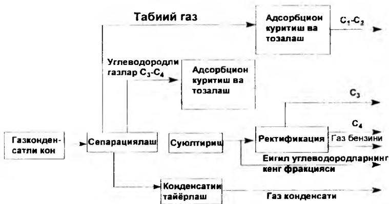
6.9-рasm. Табиий газни tayyorlashning blok-sxeması.
