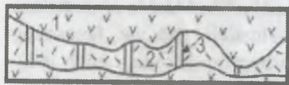
30-rasm. Kanava tuproq qatlami, tomirni gorizontal yo'nalgan tomoni 1- o'zgaruvchan jinslar; 2- ma'dan; 3- shtuf.
