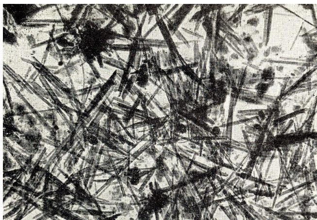
28-расм. Палигорскит суспензиясининг электрон-микроскопик сурати.
