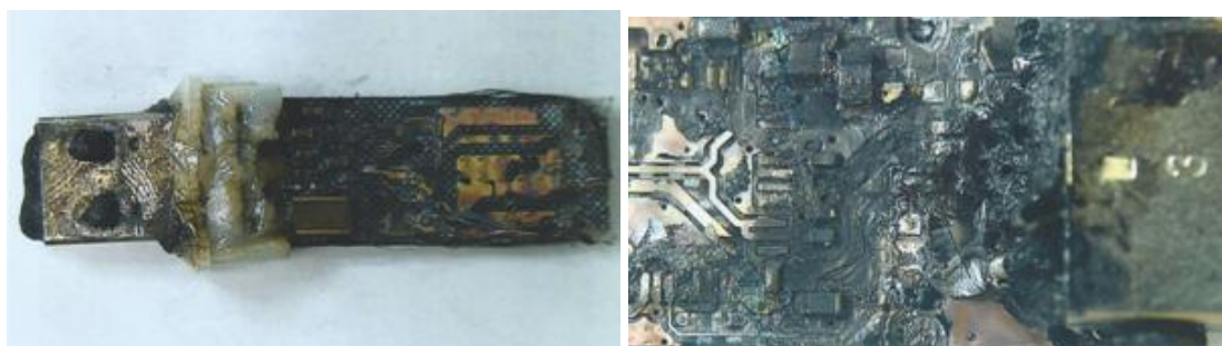
28-rasm. Kuchli magnit maydoni natijasida USB flesh saqlagichining o'zgarishi
