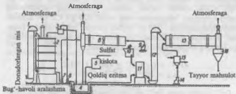
7.6-rasm. Donadorlangan misdan mis kuporosi ishlab chiqarish sxemasi: 1 va 12 – kovshli elevatorlar; 2 – yuvuvchi minora; 3 – bir xil darajali bak; 4 – qoldiq eritma yig'gichi; 5 – sulfat kislota uchun sarflash baki; 6 va 7 – markazdan qochma nasoslar; 8 – aylanuvchi kristallizator; 9 va 14 – ventilatorlar; 10 – aralashtirgishli yig'gich; 11 – sentrifuga; 13 – quritgich; 15 – havo isitgichi; 16 – tayyor mahsulot bunkerlari.
