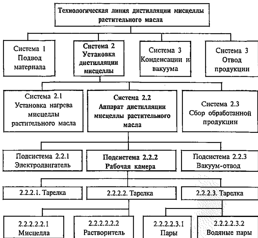
Рис. 10.2. Иерархическая структура технологической линии дистилляции мисцеллы хлопкового масла
