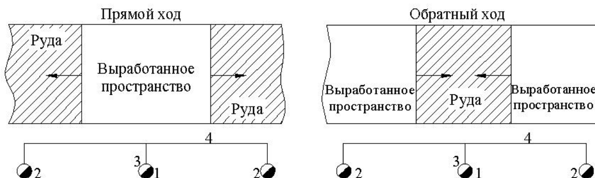
Рис. 1.3.1. Порядок отработки шахтного поля: 1 – главный вскрывающий ствол; 2 – фланговые вентиляционные стволы; 3 – квершлаг; 4 – полевой откаточный штрек
