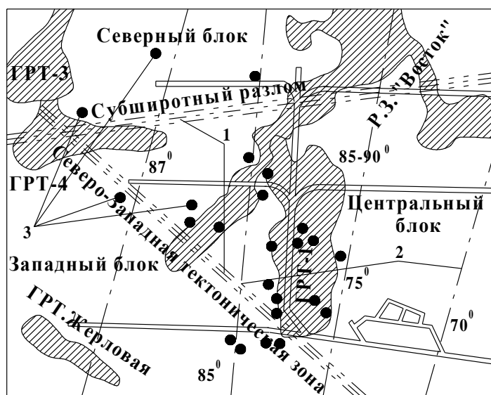
Рис. 5.2.20. Блоково-структурное строение Николаевского месторождения: 1 – структурные элементы первого порядка; 2 – то же второго порядка; 3 – места проявления горного давления в динамической форме
