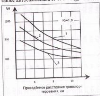
Рис. 4.4.2. Зависимость выработки автосамосвалов ( \text{м}^3/\text{смена} ) от приведенного расстояния транспортирования (эталонный вариант): 1 - R-170 ( 60 \text{ м}^3 ); 2 - HD-1200 CAT ( 47 \text{ м}^3 ); 3 - Белаз ( 37 \text{ м}^3 ).
