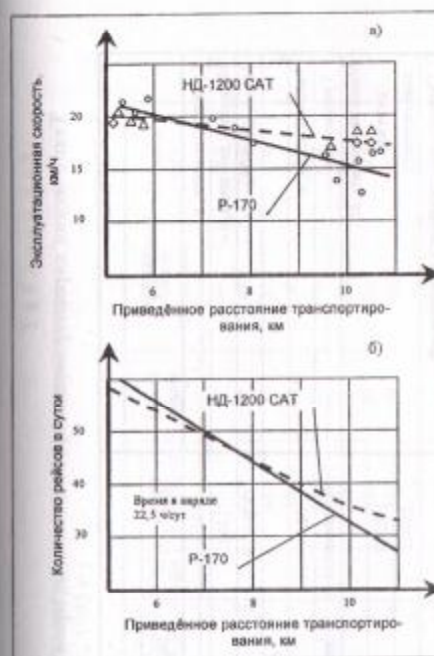
Рис. 4.4.1. Зависимость эксплуатационной скорости (а) и количества рейсов (б) от приведенного расстояния транспортирования: ○ R-170 ◇ CAT △ HD-1200
