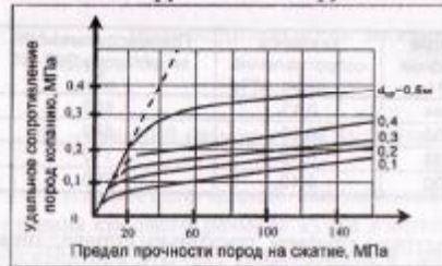
Рис. 3.3.3. Зависимость удельного сопротивления разрыхления массива копания от предела прочности пород на сжатие при различных средних размерах кусков взорванной горной массы.
