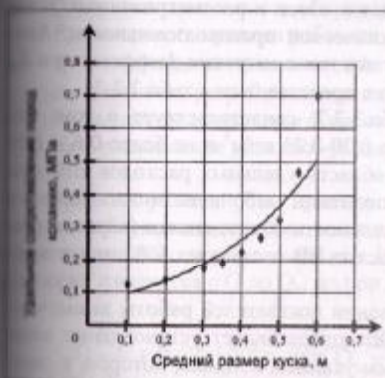
Рис.3.3.2. Зависимость удельного сопротивления пород копанью от среднего размера куска взорванной горной массы.
