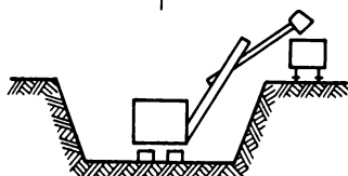
Рис. X.28. Маркшейдерские работы при проходке траншеи сплошным забоем с отгрузкой породы в вагоны
