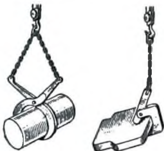
Рис. 11. Строповка отливок специальными приспособлениями
