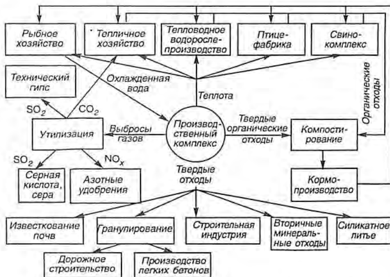
Рис. 3.36. Принципиальная схема безотходного промышленного производства
