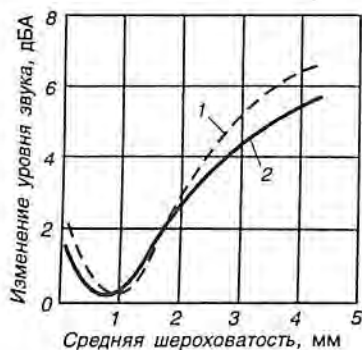
Рис. 3.15. Зависимость изменения уровня шума от средней шероховатости покрытия при движении АТС:
