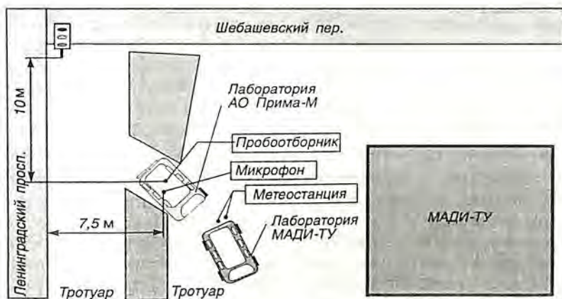
Рис. 6.3. Расположение поста мониторинга загрязнения окружающей среды и транспортных потоков
