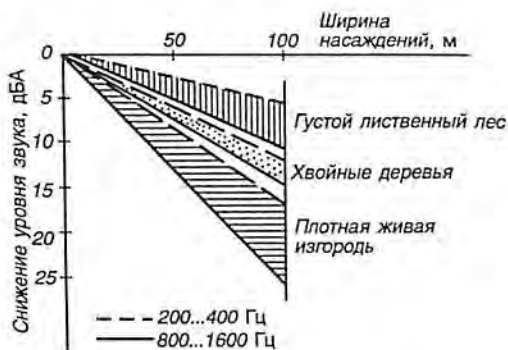
Рис. 3.19. Зависимость снижения уровня звука от ширины зеленых насаждений и вида растительности
