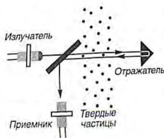
Рис. 6.2. Принцип работы прибора для оценки концентрации твердых частиц
