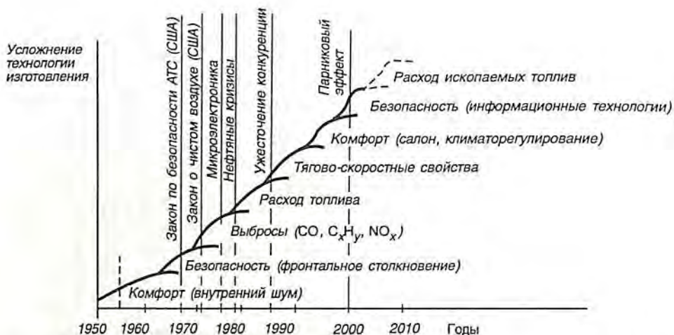
Рис. 1.8. Динамика результирующего вектора требований к конструкции легковых автомобилей
