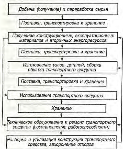
Рис. 1.1. Схема жизненного цикла объекта транспорта
