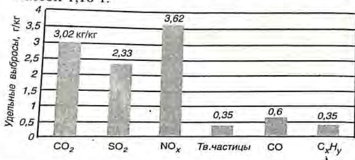
Рис. 3.12. Удельные выбросы вредных веществ при изготовлении легкового автомобиля [28]
