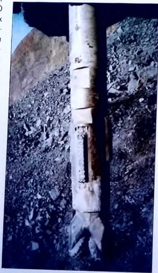
Рис. 4. Наддолотный стабилизатор на станке СБШ-250МН
