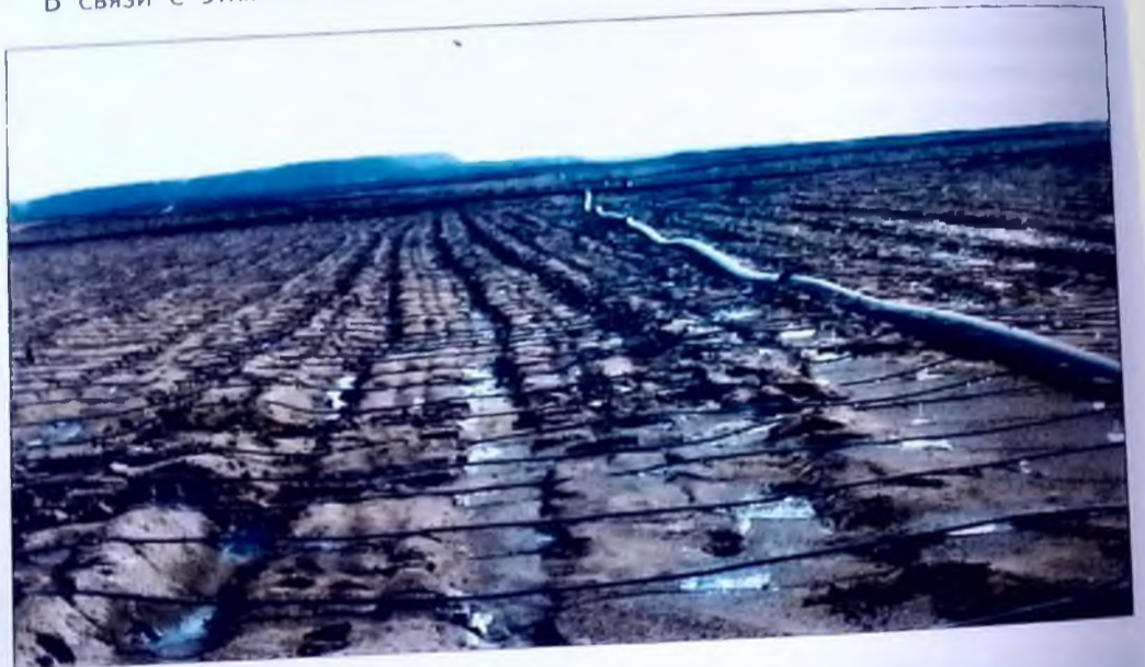
Капельное орошение поверхности штабеля руды
