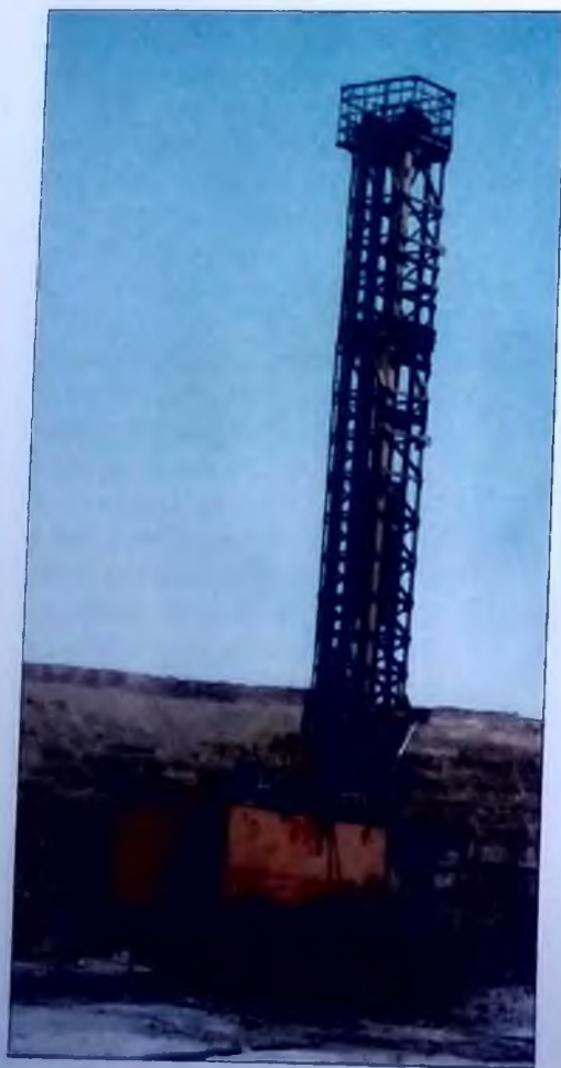
Рис. 1. Модернизированный станок СБШ-250МНА с удлиненной мачтой
