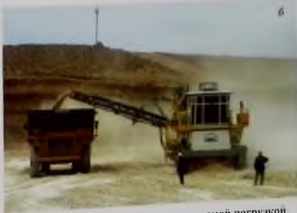
Рис. 1. Фрезерные комбайны Wirtgen-2100SM (а) и MTS-250 (б) на разработке фосфопласта с прямой погрузкой руды в самосвалы
