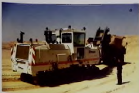
Рис. 1. Фрезерные комбайны Wirtgen-2100SM (а) и MTS-250 (б) на разработке фосфопласта с прямой погрузкой руды в самосвалы
