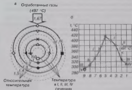
Рис. 4. Температурное поле в горизонтальных (а) и вертикальных (б) сечениях нагревателя первичного двигателя стирлинг-электрической установки при частоте вращения коленчатого вала поршневого ДВС n = 1500 \text{ мин}^{-1} (обозначения точек замера см. на рис. 3)
