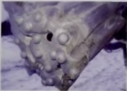
Карьер «Селерский», Свердловская обл. Перфораторная буровая коронка КНШ-115.Т60. АRS МХ28.00 производства ЗАО «МХ»
