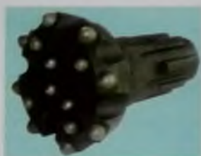
Рис. 1 Шлицевая буровая коронка КНШ-110БШКЕ40 до и после проходки 350 м. г. Дананг
