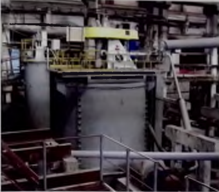
Рис. 2. Флотационная машина РИФ 100 в цикле дозвращения цветных и благородных металлов из отвальных хвостов
