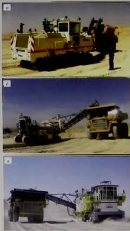
Рис. 1. Разработка фосфоритового пласта с помощью комбайнов Wirtgen-2100SM (а), MTS-250 (б) и Wirtgen-2500SM (в) с погрузкой в самосвалы
