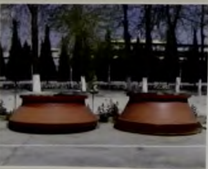
Рис. 5. Футеровка конуса и чаши дробилок II и III стадий дробления цеха кучного выщелачивания золота
