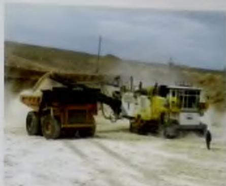
Разработка пласта фосфоритов фрезерным комбайном фирмы Map Taqtaf
