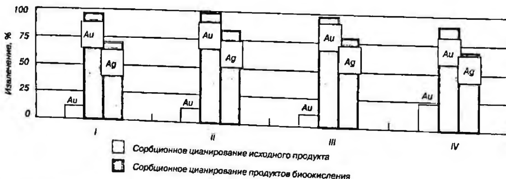
Рис. 2. Показатели извлечения благородных металлов из упорных концентратов Майкopsкого (I), Кутайнского (II) месторождений и Верхне-Качанской зоны Декдеспского рудного месторождения при бактериальном выщелачивании
