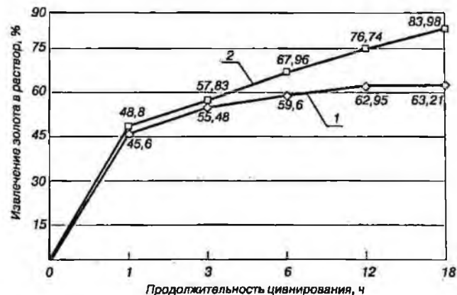
Рис. 4. Изменение показателей цианирования золотосодержащей руды во времени: 1 — без ультразвуковой обработки; 2 — с обработкой
