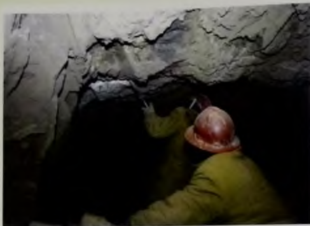
Заверочное бороздовое опробование по кровле штреков № 6 и 7 (штольня № 2)
