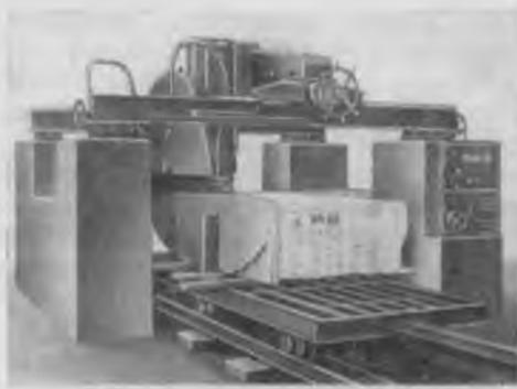
полное использование диаметра диска и значительные удельные энергозатраты. Поэтому дисковые станки чаще всего применяют для опиливания — пассивки блоков мрамора, известняка, туфа; для резки блоков из тех же горных пород на крупные архитектурно-строительные детали или на первичные бруски — заготовки, которые затем режут на тонкие плиты на многодисковых распиловочных станках.
