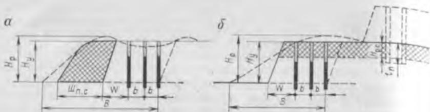
Рис. 5.12. Схемы взрывания в зажатой среде:
