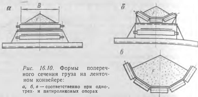
Рис. 16.10. Формы поперечного сечения груза на ленточном конвейере:
