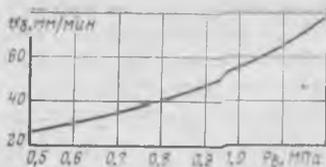
Рис. 4.7. График зависимости скорости пневмоударного бурения  $v_b$  от давления воздуха  $P_{в}$  ( $P_0 = 14 \div 16$ )
