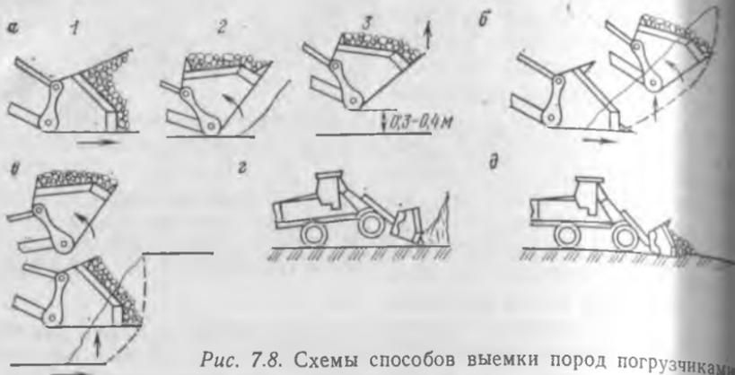
Рис. 7.8. Схемы способов выемки пород погрузчиками
