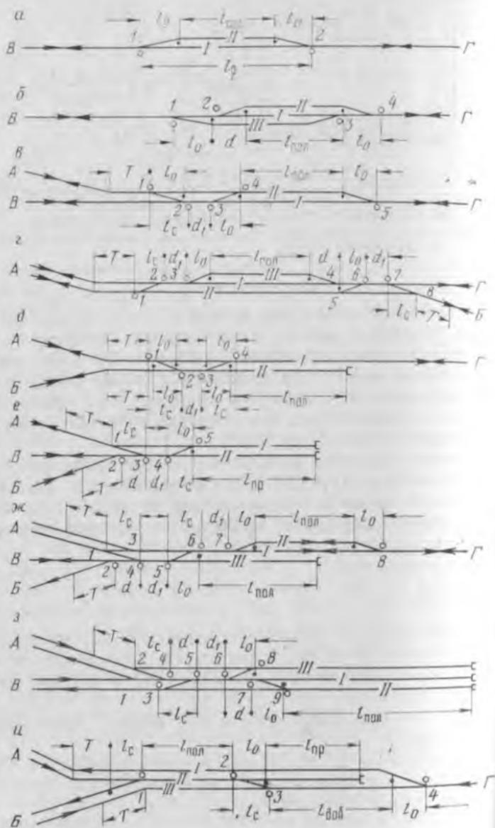
Рис. 12.5. Конструктивные схемы развязок:
