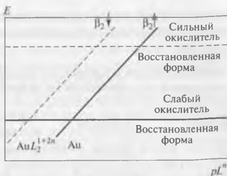
Рис. 14.1. Схематическое изображение диаграммы Eh - pL^n
