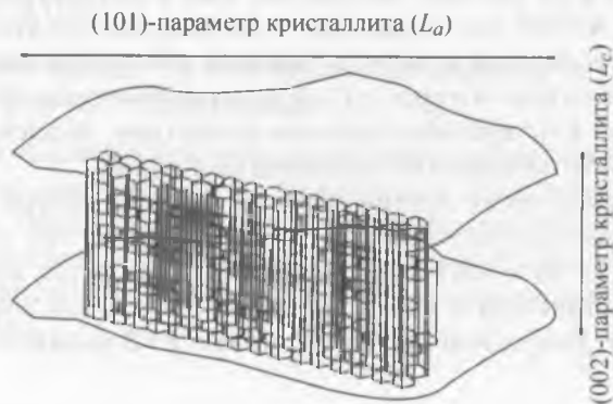
Рис. 24.3. Диаграмма, показывающая условные параметры кристаллита с графитовой структурой, содержащей «сборки» бензольных колец
