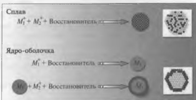
Рис. 6.12. Схема водного синтеза кластеров металлов M_1 и M_2 со структурой сплава и ядро-оболочки [23]
