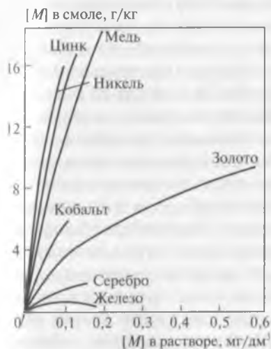
Рис. 21.7. Изотермы сорбции цианидных комплексов цветных металлов, железа и серебра из производственных («Грутвлей», ЮАР) насыщенных растворов сильноосновной смолой A101-DU [8].
