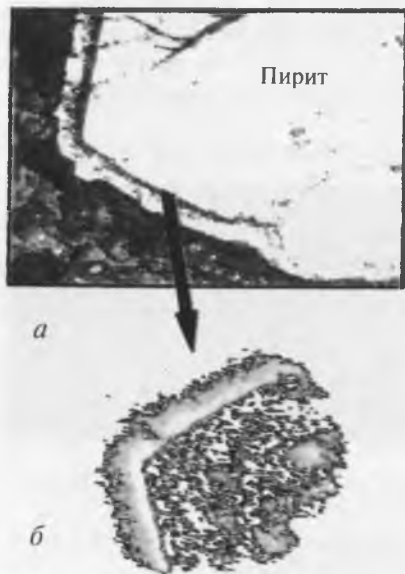
Рис. 25.3. Микрофотография участка зерна FeS_2 с оболочкой мышьяковистого пирита, полученная электронным сканированием (а), и изображение зон, обогащенных мышьяком (выделены красным цветом, б)
