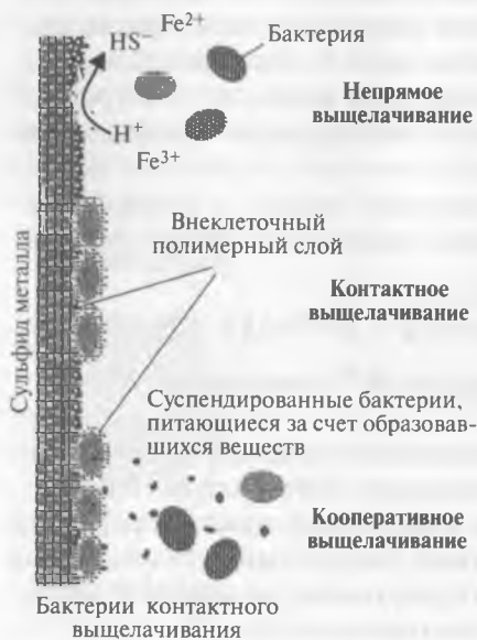
Рис. 11.5. Варианты биовыщелачивания металлического сульфида [29]
