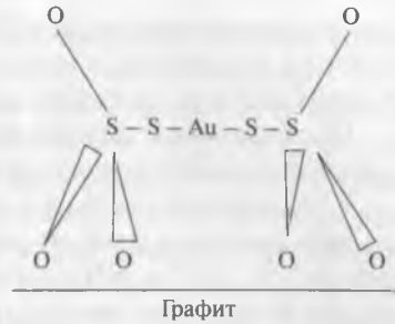
Рис. 16.13. Стереорасположение тиосульфатного комплекса золота на поверхности графита
