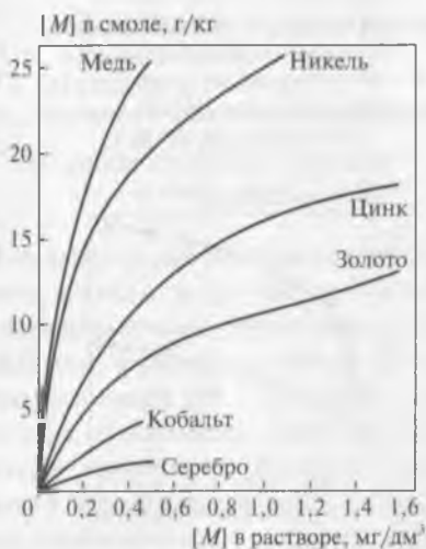
Рис. 21.8. Изотермы сорбции цианидных комплексов цветных металлов и серебра из производственных («Дурбан Дип Родепорт», ЮАР) насыщенных растворов сильноосновной смолой IRA-400 [8].
