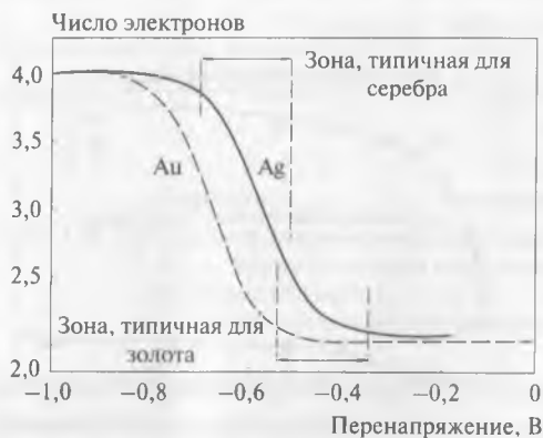
Рис. 13.21. Соотношение между числом электронов, участвующих в процессе растворения золотого и серебряного электродов. Цианидные растворы насыщались воздухом, \omega = 300 \text{ мин}^{-1} , температура 24^\circ\text{C}
