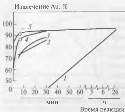
Рис. 13.30. Влияние времени цианирования и давления кислорода на степень извлечения золота при 20 °С: 1 – атмосферное давление; 2 – P_{O_2} = 0,5 МПа; 3 – P_{O_2} = 1,0 МПа; 4 – P_{O_2} = 5,0 МПа; 5 – P_{O_2} = 20 МПа
