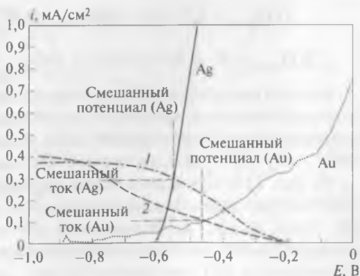
Рис. 13.17. Сравнение процессов растворения золота и серебра в цианидном растворе ( [\text{CN}] = 0,01 \text{ моль/дм}^3 ) и относительное расположение кривых, характеризующих восстановление кислорода: 1 — кислород (Ag + воздух); 2 — кислород (Au + воздух)
