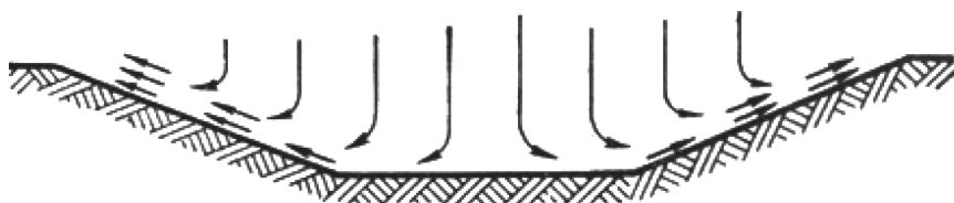
7.8-rasm. Konvektiv sxemada shamollatishda karyer havosining harakatlanishi.
