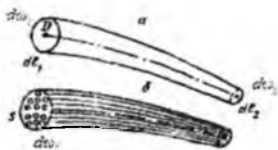
3.2- rasm. Oqim naychasi. elementar oqimcha va oqim.
