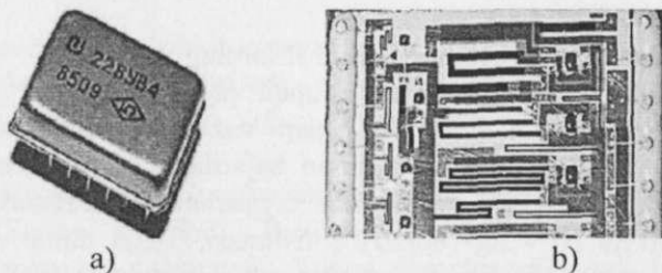
1.6-rasm. Gibrid mikrosxemaning tashqi ko'rinishi (a) va bo'lagining kattalashtirilgan tasviri(b)
