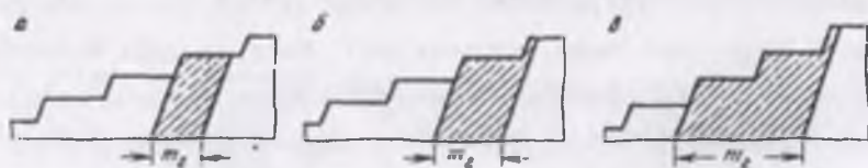
1.16. - rasm. Juda kichik va kichik (a), o'rtacha (b) va katta (v) qalinlikdagi qiya va tik qiya konlarni qazib olish sxemasi:
