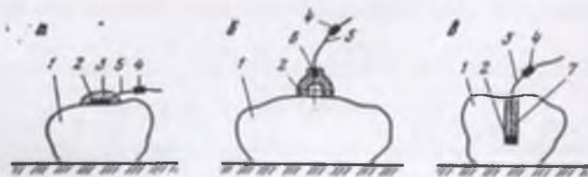
2.11. - rasm. Nogabaritlarni maydalashda zaryadlarning joylashish sxemasi:
