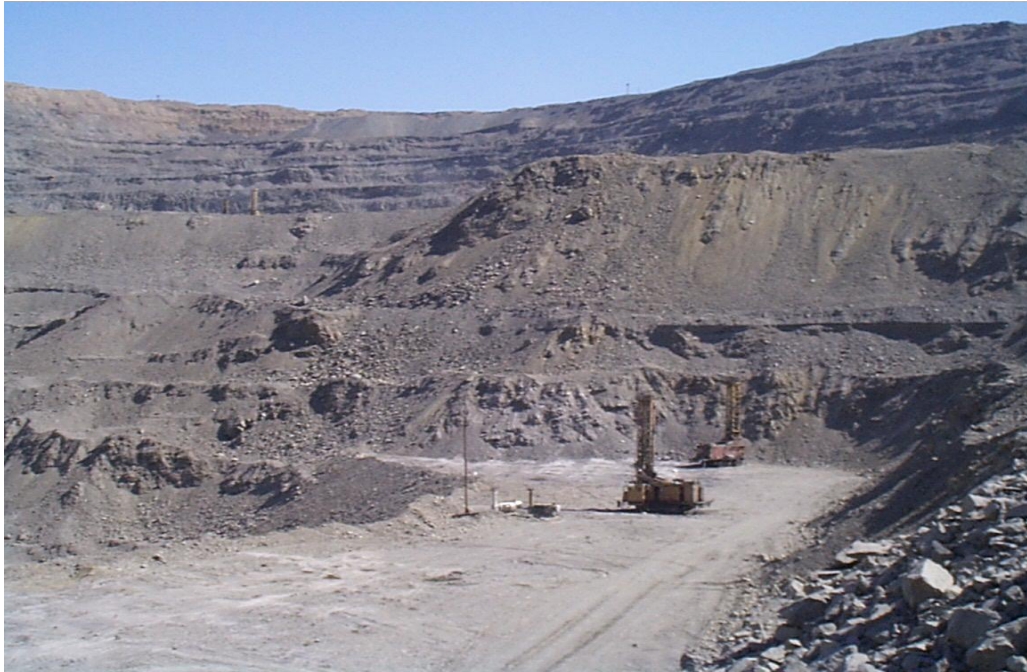
4.7 – rasm. Muruntov kar'yerida burg'ulash ishlari..
