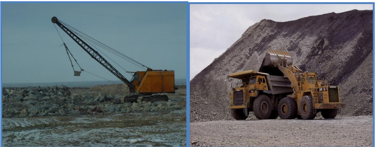
5.8 – rasm. Kar’yerda draglayn va yuklagichlar yordamida qazish-yuklash jarayoni.
