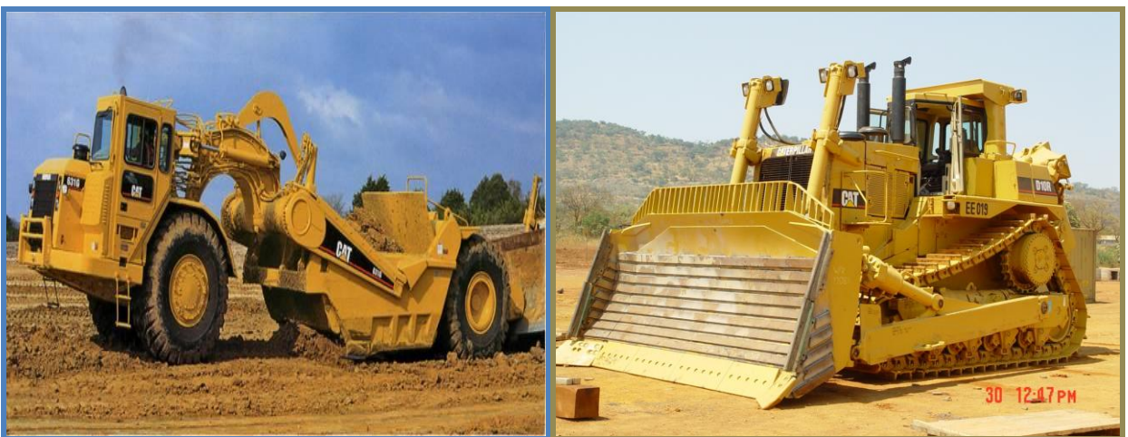
5.9 – rasm. Kar’yerda skreper va buldozerlarning ish jarayoni.
