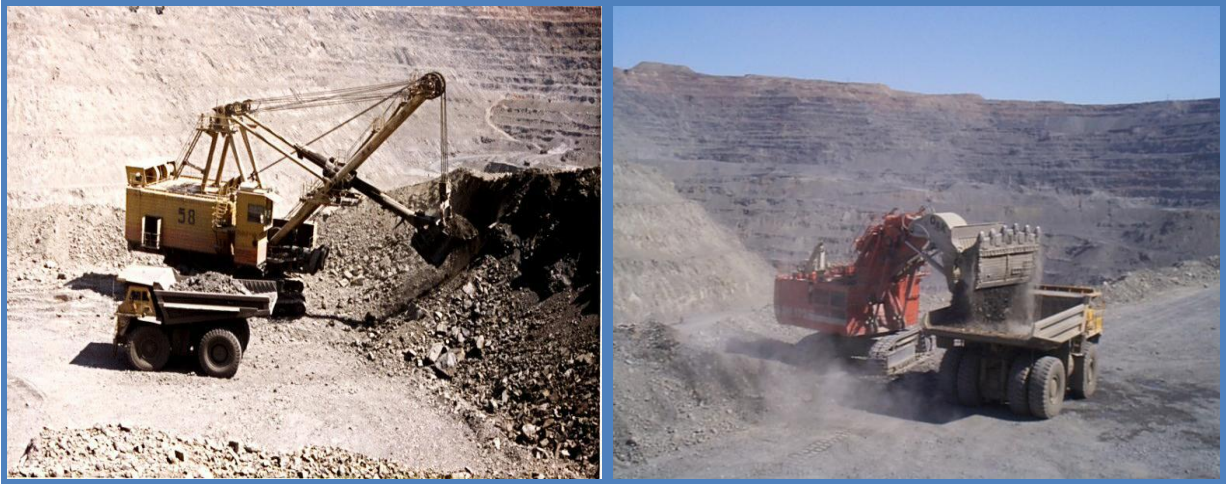
5.7 – rasm. Kar’yerda bir kovshli ekskavatorlar yordamida qazish-yuklash jarayoni.
