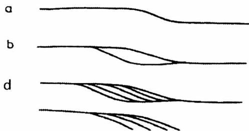
37-rasm. «Ot dumi» strukturasi rivojlanishi: a – sigmasimon egri chiziq; b – sigmasimon sirtmoq; d – murakkablashgan sigmasimon sirtmoq; e – «Ot dumi» strukturasi
