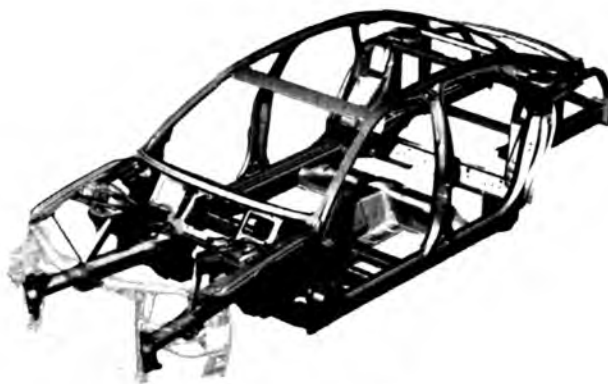
4.9-rasm. Yengil avtomobilning ko'tarib turuvchi kuzov karkasi.
