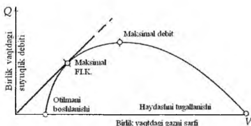
8.8-rasm. Suyuqlik debitining gaz sarfiga ( V ) \xi=const bo'lgandagi bog'lanish grafigi tasvirlangan. Ko'targich diametri d_k = 73 mm.
