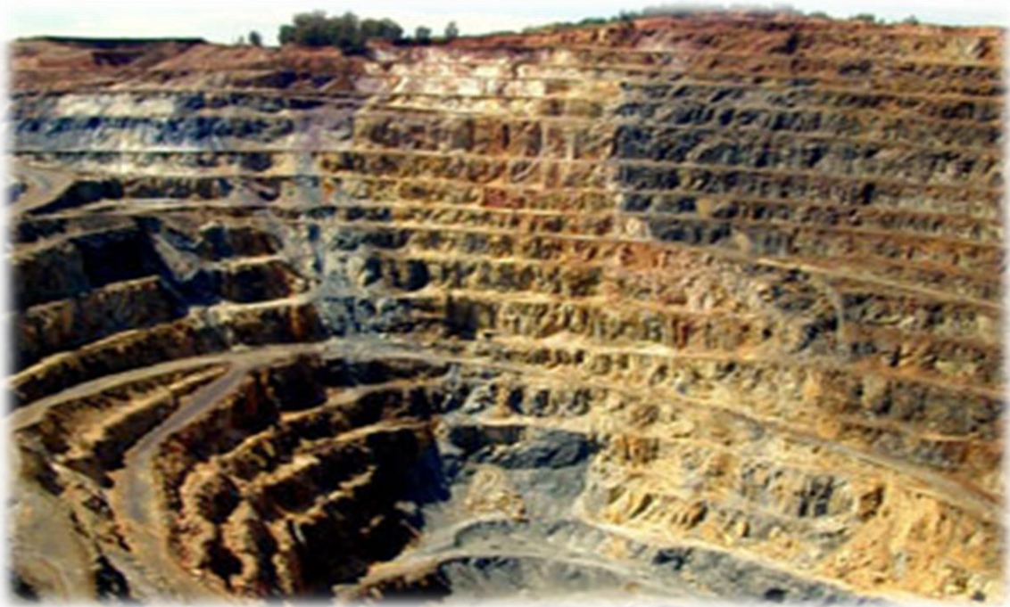
26-rasm. Konlarni ochiq usulda (Kar'yer) qazib olinishi.
