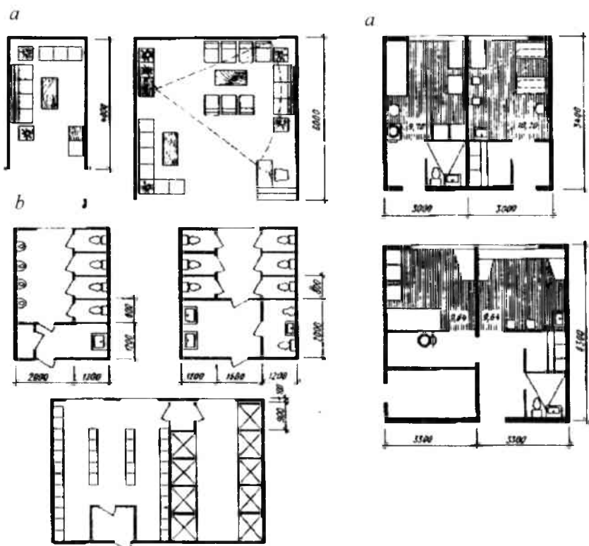
4.9-rasm. Xizmat ko'rsatish xonalarining unifikatsiyalangan tiplari: a – qavatlardagi xollar, b – umumiy sanitariya tugunlari va dush xonalari, v – xizmat ko'rsatuvchi xonalarining qavatli bloki
