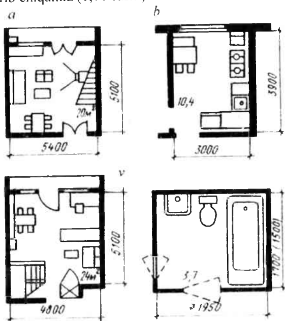
1.11-rasm. Qishloq binolari xonalarining tarhiy tavsiflari: a-zina bilan umumiy xona, b-isitish jihozi bilan jihozlangan oshxona, v-sanitariya xonasi suv isitish moslamasi bilan.
