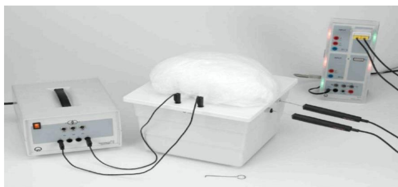
3.3.4-rasm. Yakka plastina metodidan foydalanib, qurilish materiali namunasining issiqlik o'tkazuvchanligini aniqlash.
