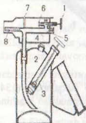
137 – rasm. Kavsharlash lampasi: 1 – ventil, 2 – rezervuar, 3 – nasos, 4 – palla, 5 – truba, 6 – jiklyor, 7 - benzin bug'leri, 8 - issiqlik.
