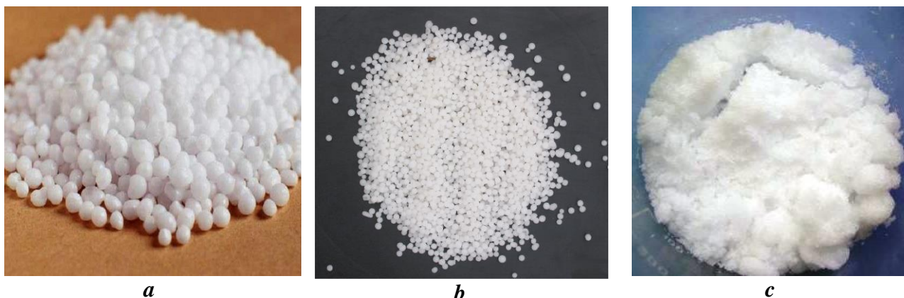
17.2-rasm. Azotli o'g'itlar: a) ammiakli selitra ( NH_4NO_3 ); b) natriyli selitra ( NaNO_3 ); c) kaliyli selitra ( KNO_3 )
