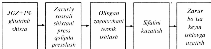
54-rasm. Temir-grafit kukunlaridan vtulkani tayyorlash texnologik jarayoni sxemasi.
