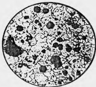
4.6-rasm. Yuqori puxtalikdagi choʻyan mikrostrukturasi, x100:
