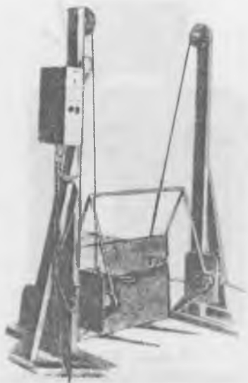
12- rasm. YPCM-11 tipidagi ko'targich: 1 – boshqarish pulti; 2 – ustun.
