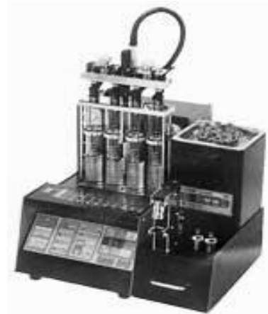
17.2-rasm. Traktor va avtomobil dvigatellarining 4 ta injektorini bir yo'la tekshiradigan ultratovushli NA4DFV stendi
