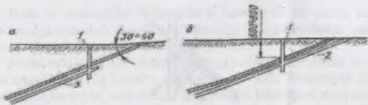
2.8-rasm. Chuqur gorizontlarni kombinatsiyalashtirib tik va qiya stvollar bilan ochish: 1 - tik stvol; 2 - qiya stvol; 3 - qiya ko'r stvol.
