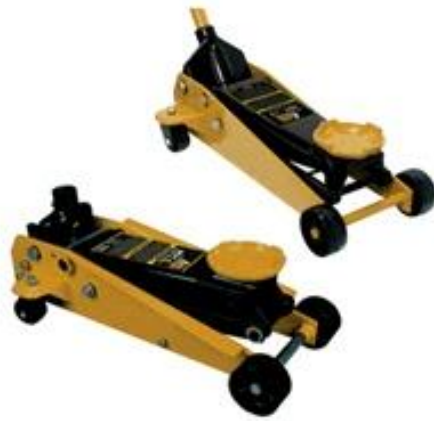
6.17-rasm. MEGA MG-20 rusumli harakatlanuvchi, yuk ko'tarish qobiliyati 20 tonnaga ega bo'lgan gidravlik va SHINN FU rusumdagi pnevmogidravlik domkratlar
