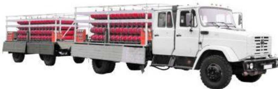
2.22 – rasm. Metan tashuvchi va tarqatuvchi avtopoyezd.
