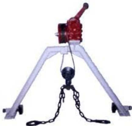
6.19-rasm. Agregatlarni avtomobildan yechib olish lebedka va elektr tali
