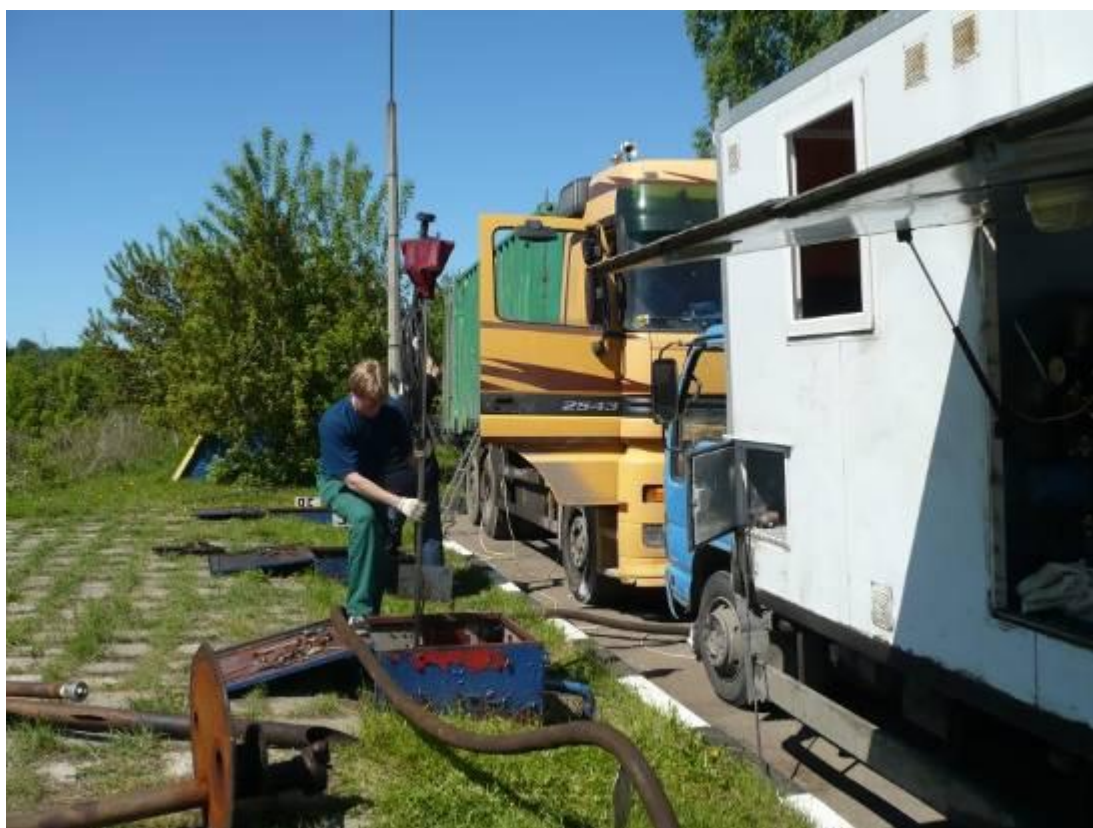
3.4 – rasm. Yerosti rezervuaridagi yonilg'i sathini o'lchash.
