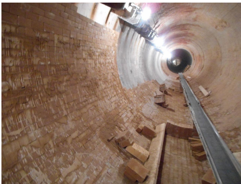
2.5-rasm. Ichki qismi qoplamasi o'tga chidamli g'ishtlardan tayyorlangan aylanuvchi barabanli pechning ko'rinishi.
