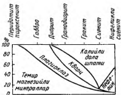
34-расм. Чуқурликда юзага келган магма жинслардаги жинс ҳосил қилувчи минералларнинг бир-бирига муносабатини кўрсатувчи схема.
