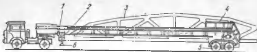
169-рasm. Ферма ташувчи (фермовоз) ихтисослаштирилган автопоезд 1 — тортиш мосламаси (лебедка), 2 — ихтисослаштирилган рама, 5 — орқа аравача ёлдираги, 6 — йиғилувчи таявч.
