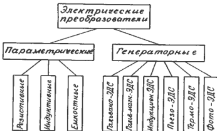
Рис. 2.5. Классификация первичных электрических преобразователей
