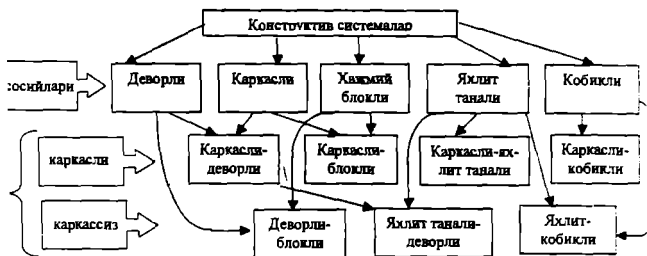
2-расм. Турар жой биноларининг конструктив схемалари классификацияси.
