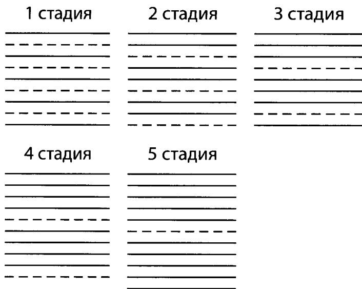
Рисунок 23.1 — Стадии внедрения атомов реагента: сплошная линия — слой из углеродных атомов; штриховая — слой из атомов внедренного вещества
