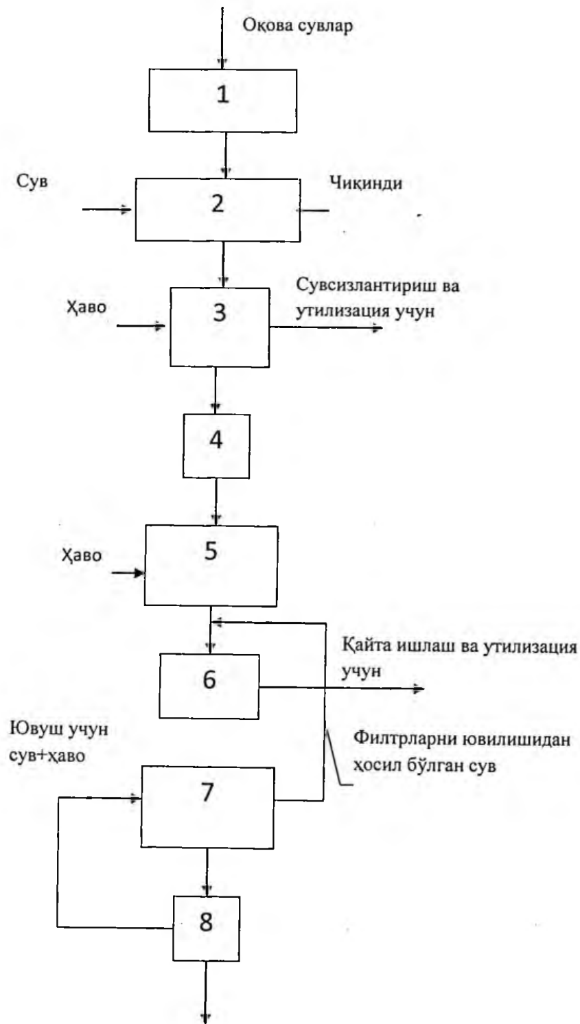
11.1-расм. Саноат окова сувларини механик тозалаш схемаси.
