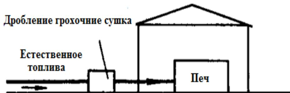
**Рис: 11.1. Общие схема сжигания в слоевых топках**
