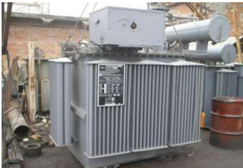
**Рис.16.4. Печные трансформаторы:**
