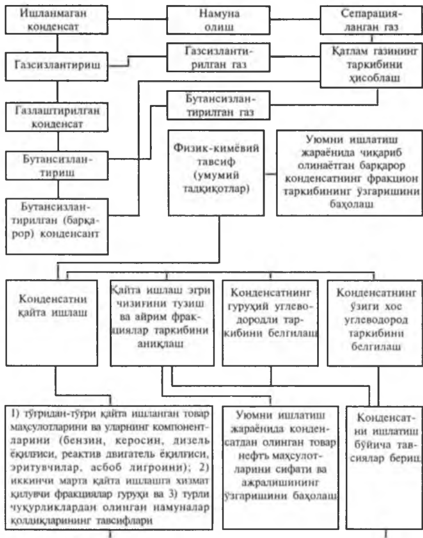
VII.19- расм. Газ ва конденсат намуналарини тадқиқот қилиш схемаси
